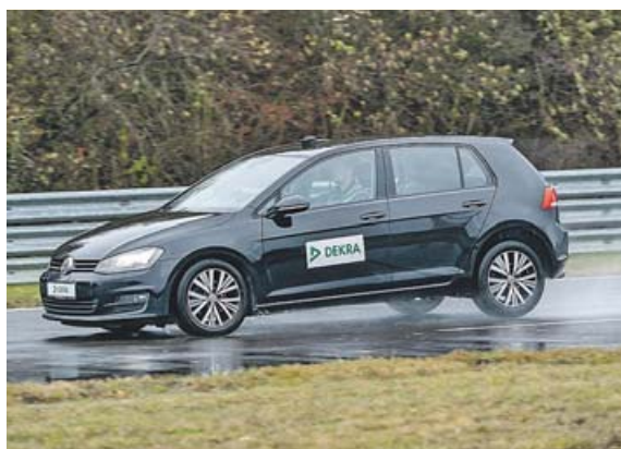
Vollbremsung aus 160 km/h: Mit erneuerten Bremsen, Reifen und Stoßdämpfern verringert sich der Bremsweg deutlich. Foto: DEKRA / Thomas Küppers
