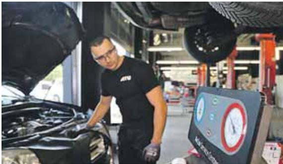
Alle zwei Jahre sollte die Auto-Klimaanlage gewartet werden. Dies beugt teureren Bauteilschäden vor. Foto: ATU
