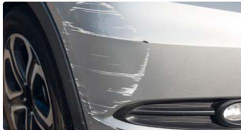
**Sieht harmlos aus, kann aber unangenehme Folgen haben: Wenn die Befestigungen des Stoßfängers angebrochen oder innenliegende Bauteile beschädigt sind, gefährdet das unter Umständen die Fahrsicherheit. Laien können das kaum feststellen - deswegen sollte immer eine Werkstatt aufgesucht werden.**
