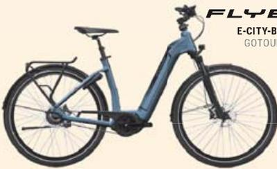
Bosch Performance Line Antrieb, 625 Wh Akku, Shimano hydr. Scheibenbremsen, Shimano 5-Gang Nabenschaltung mit Gates Riemenantrieb
