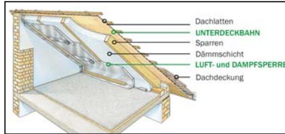
**Luftdichtigkeit ist eine der wichtigsten Voraussetzungen für ein dauerhaft wärmedämmendes, funktionssicheres Dach. Deswegen ist eine fachgerecht verlegte Luft- und Dampfsperre auf der Innenseite unverzichtbar.**
