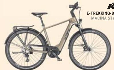
Bosch Performance CX Smart System Antrieb, 750 Wh Akku, Shimano hydr. Scheibenbremsen, Shimano Deore XT 11-Gang Schaltung
