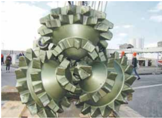
Solch ein Bohrkopf kommt bei Probebohrungen für die Tiefengeothermie zum Einsatz. Foto: pst
