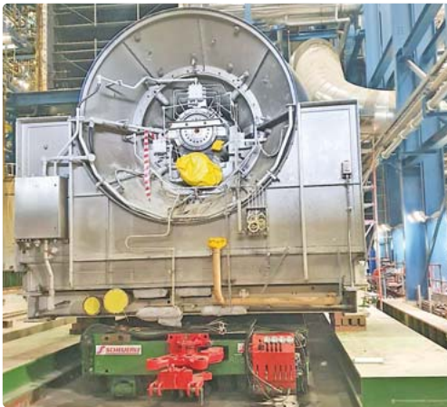
Eine der beiden neuen Gasturbinen der GuD2 beim Einbringen an ihren Standort. Bild: SWM
