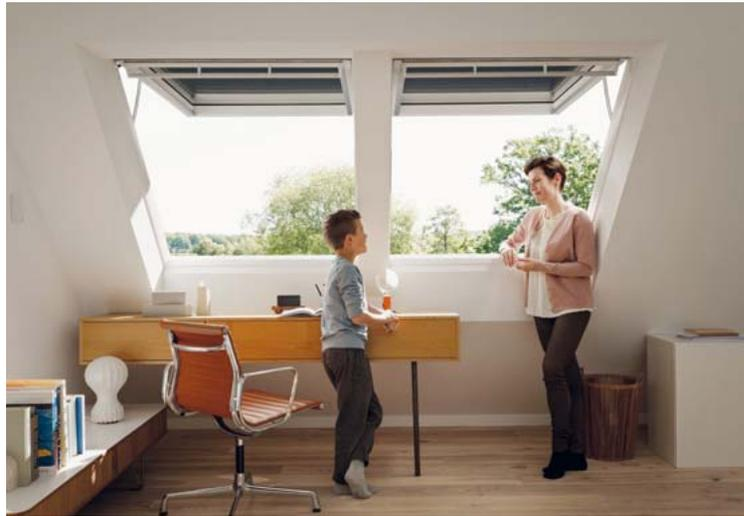
**Elektrische Klapp-Schwingfenster als Alleskönner: Während die Klappfunktion komfortabel elektrisch steuerbar ist, lässt sich die Schwingfunktion des Fensters jederzeit manuell bedienen.**
