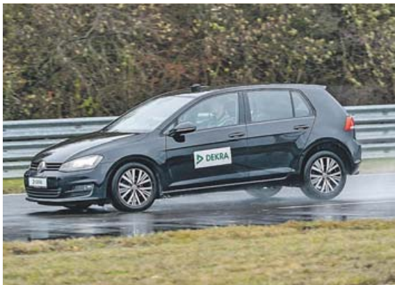
Vollbremsung aus 160 km/h: Mit erneuerten Bremsen, Reifen und Stoßdämpfern verringert sich der Bremsweg deutlich. Foto: DEKRA / Thomas Küppers
