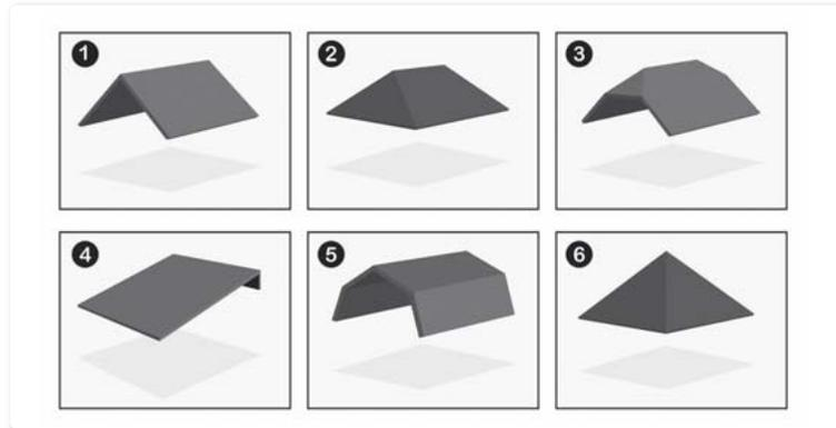
**Ob Satteldach (1), Walmdach (2), Krüppelwalmdach (3), Pultdach (4), Mansarddach (5) oder Zeltdach (6): Die Formgebung hat großen Einfluss auf die Wirkung eines Gebäudes.**
