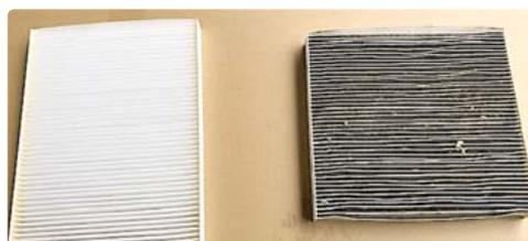
Zwei Innenraumfilter, rechts verschmutzt, links neu. Bild: Hauser & Knorr
