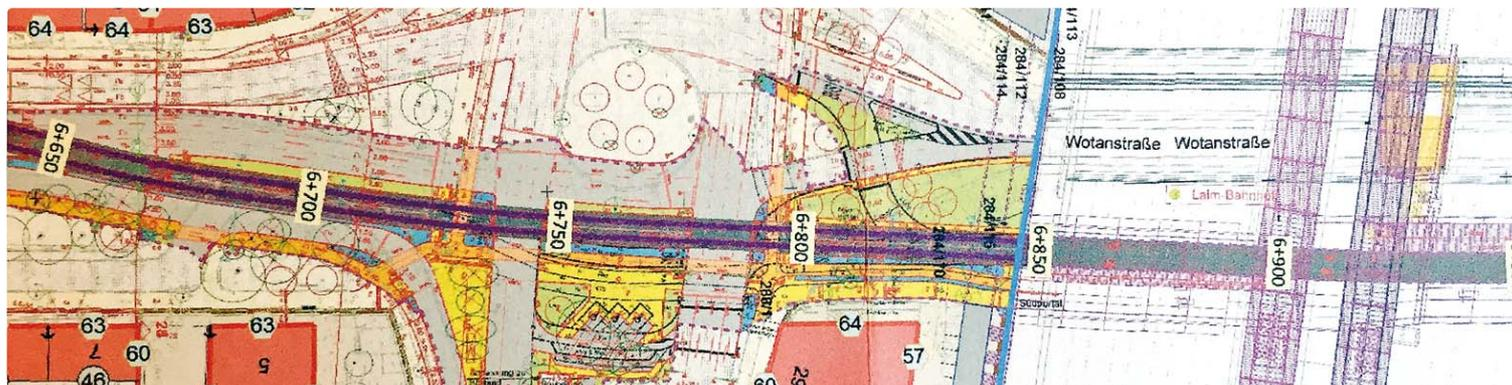
Die Planung am Laimer Kreisel und in der Laimer Röhre (rechts). Die Tramtrasse (lila Linien auf der durchgehenden grauen „Schneise“ in der Mitte des Plans) schwenkt von der Fürstenrieder Straße (links) etwas nach Osten (im Bild ist das unten) ab und führt (hinter der blauen Trennlinie) in die eigene Röhre. Dort befinden sich eine Haltestelle mit Zugang zur S-Bahn Laim. Bild: job
