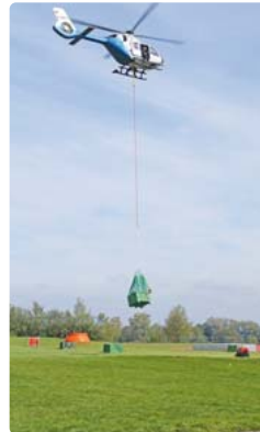
Das Material wird in Kisten, die mit einem Netz zusätzlich gesichert wurden, transportiert.
