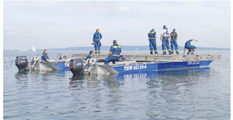
Das Technische Hilfswerk hat diesen Schwimmponton als Landefläche aufgebaut.
