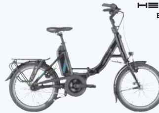
Bosch Active Line Antrieb, 400 Wh Akku, Shimano 7-Gang Nabenschaltung mit Freilauf oder Rücktrittbremse, Bosch Purion Display
