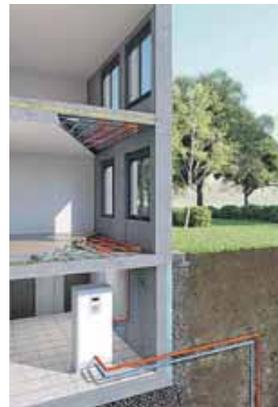
**Heizen oder kühlen nach Bedarf: Bei der sogenannten Bauteilaktivierung wird ein Rohrsystem für warmes oder kaltes Wasser in die Betonteile integriert.**
